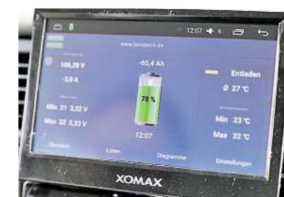
Die Ladeanzeige (o.) erfolgt auf einem Radio-Display, der E-Motor (u.) ist einfach ans Getriebe angeflanscht.
